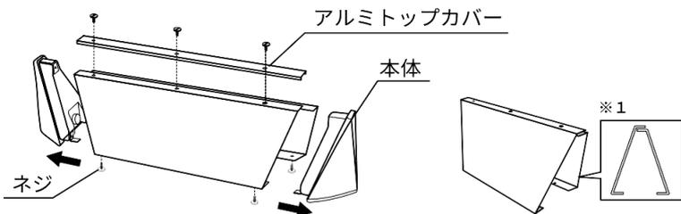
1. 上部と下部のネジを外し、面板両側から本体を外します。
