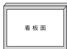
両端45°カットしたアンクルを まわりに巻いて完成です
